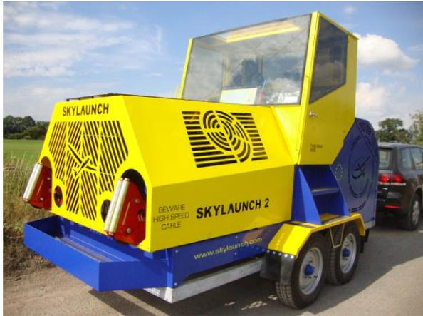
Die kompakte und bewährte Konstruktion mit 1 oder 2 Seiltrommeln und Seillängen bis zu 3500 m ist einfach zu bedienen, liefert sichere Starts mit großen Ausklinkhöhen und ist in 4 verschiedenen Ausbaustufen erhältlich. Skylaunch-Winden garantieren eine hohe Verfügbarkeit, einfache Wartung und niedrige Betriebskosten.
